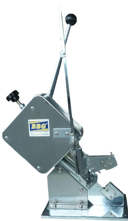
**Es una maquina de accionamiento manual para cerrar embutidos de tripa natural o artificial, mallas y bolsas, llenas o vacias, con un clip de aluminio.**
