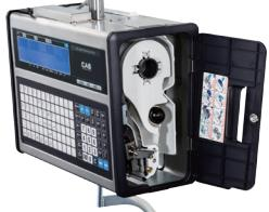
El cartucho de papel permite un reemplazo rápido y sencillo del rollo de etiquetas.
