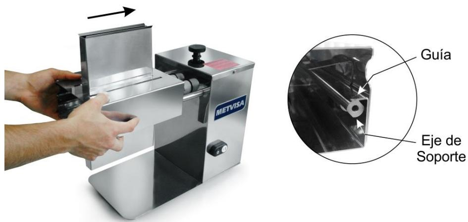
Cuando vuelva a montar los rodillos en el cajón, coloque la ranura del rodillo en el interior del cajón. Tenga en cuenta que en el rodillo 01 hay un disco y debe montarse contra la placa del cajón. Otra atención que debes tener está relacionada con la primera hoja del rodillo 02. La hoja tendrá que estar detrás del disco del rodillo 01, como se muestra en la imagen siguiente.
