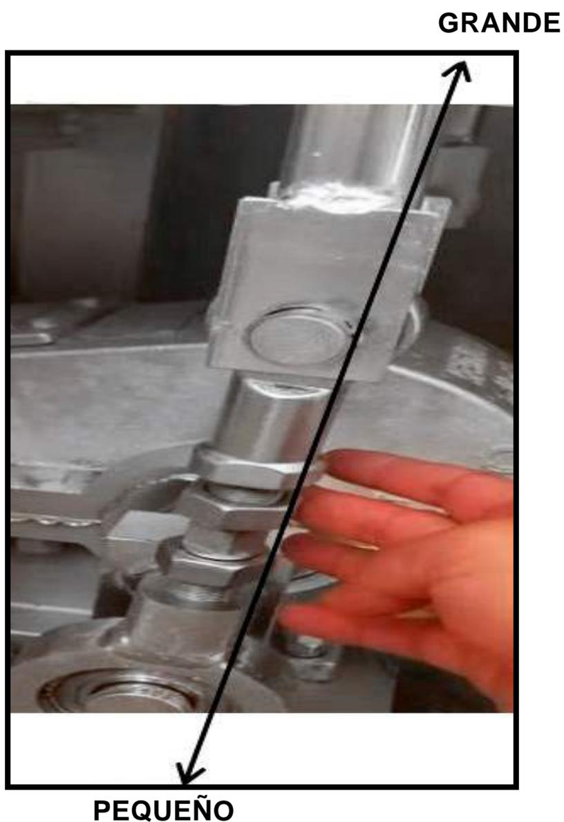
Abra la distancia hacia arriba y hacia abajo del tornillo de ajuste del pasaporte para ajustar la fuerza de corte.
